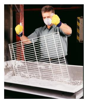
HYBRID FLUIDIZED BED-ELECTROSTATIC APPLICATION
